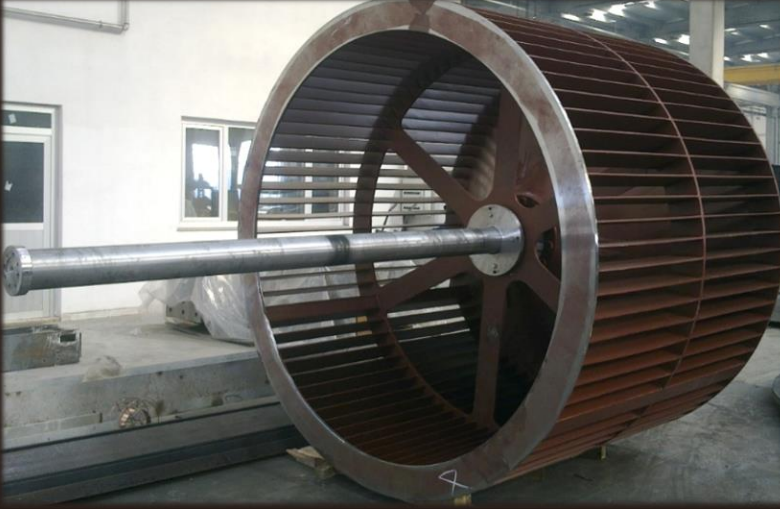
SEPERATÖR ROTORU PFEIFFER SLS 4000B K.MARAŞ ÇİMENTO FABRİKASI K.MARAŞ / TÜRKİYE 2013/2014
